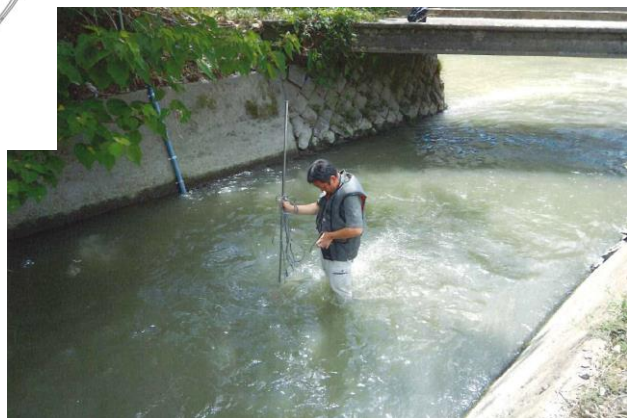
水路の流速観測
